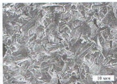
Рис. 2. Микрофотография скола керамического образца LLTO.
