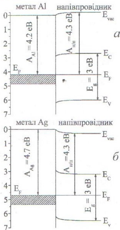
Рис. 3. Зонна діаграма контакту метал-напівпровідник, що утворюється при нанесенні на зразок (\text{Ba}_{0.996}\text{Y}_{0.004})\text{TiO}_3 + 0.004\% мол. Mn різних електродів: Al (а), Ag (б).
