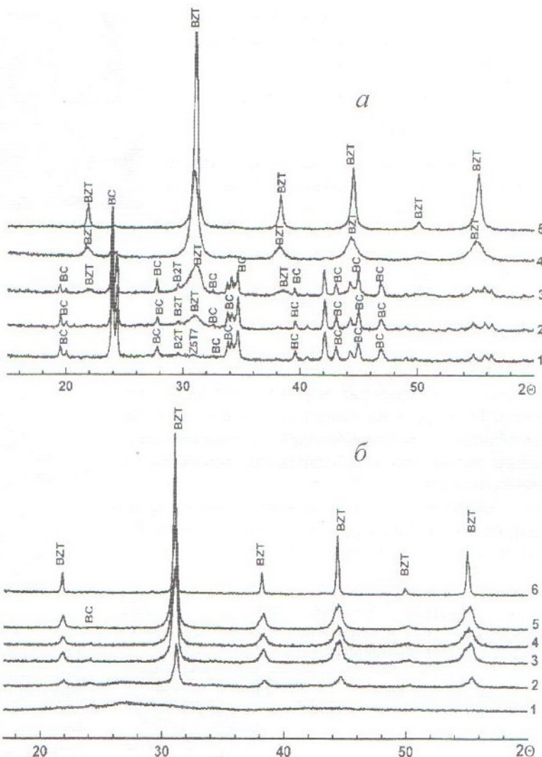
Рис. 3. Дифрактограммы шихты \text{Ba}(\text{Ti}_{0.6}\text{Zr}_{0.4})\text{O}_3 , снятые при комнатной температуре после термообработки 2 ч, полученной МПО (а): 1 – 600, 2 – 700, 3 – 800, 4 – 900, 5 – 1000^\circ\text{C} , и высокотемпературные дифрактограммы полученной ЗГМ (б): 1 – 500, 2 – 600, 3 – 700, 4 – 800, 5 – 900, 6 – 1000^\circ\text{C} . BC — \text{BaCO}_3 ; BZT — \text{Ba}_2\text{TiO}_4 ; BTZ — \text{Ba}(\text{Ti}_{0.6}\text{Zr}_{0.4})\text{O}_3 ; \text{Z}_5\text{T}_7 — \text{Zr}_5\text{Ti}_7\text{O}_{24} .
