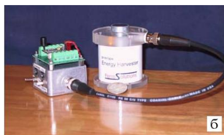
Рис. 23. а — Схема устройства для сбора паразитных магнитных полей; магнетостриктивный материал (1); направление поляризации (2); направление магнитной индукции (3); пьезоэлектрик (4); б — магнетозлектрическое устройство, собирающее энергию вибрации, изготовленное фирмой Ferro Solutions (США) (взято с сайта http://www.ferrosi.com ).
