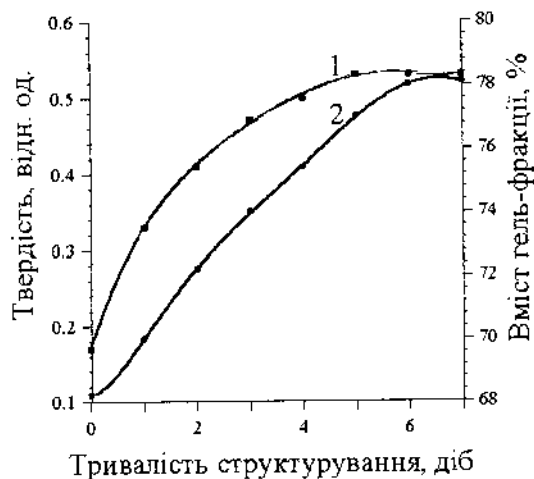
Рис. 3. Залежність вмісту твердості плівок (1) та гель-фракції (2) композиції II від тривалості структурування при кімнатній температурі.
