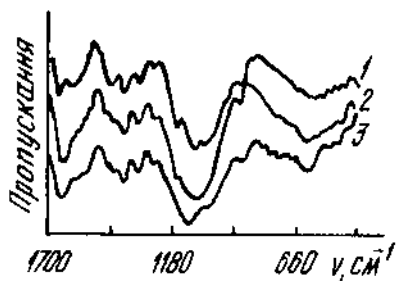
Рис. 2. ІЧ-спектри хітозану (1) та комплексів міді на хітозані C_{\text{Cu}}:C_{\text{L}}=1:3.5 (2); 1:2 (3).
