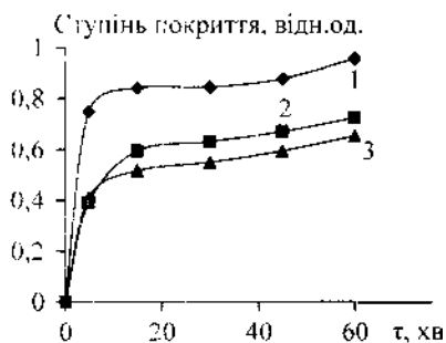
Рис. 3. Залежність ступеня покриття від тривалості обробки поверхні скла ППЕС при 383 (1), 403 (2) та 423 К (3).
