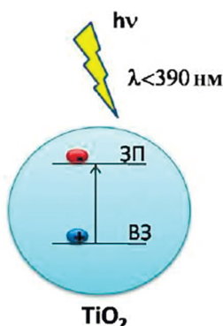
Рис. 1. Схема фотогенерації носіїв заряду [21]
