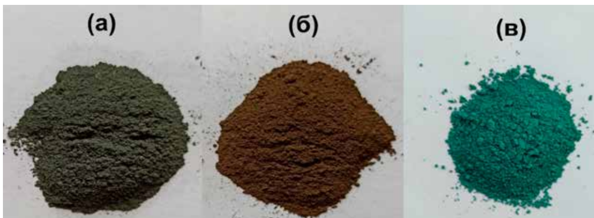
Рис. S1. Порошки, отримані (а) без та (б) із додаванням H 2 O 2 , висушені за 100 °С та (в) після відпалу
