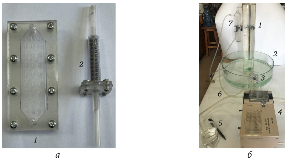
Рис. 1. Реактори для генерування водню (а): 1 – плоский; 2 – циліндричний та волюмометрична установка (б): 1 – евідіометр; 2 – кристалізатор; 3 – реактор; 4 – перистальтичний насос; 5 – стакан із лужним розчином борогідриду натрію; 6 – з'єднувальні трубопроводи; 7 – сепаратор.
