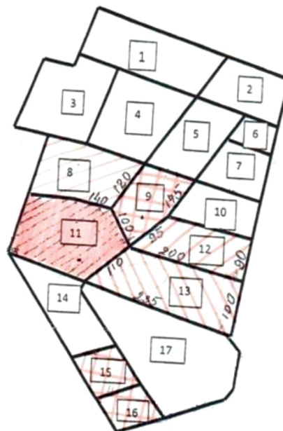
Рис. 1. Карта – схема відбору проб для аналітичного контролю
